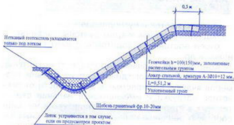
Рис. 2. Типовая схема укрепления откосов геоячейками (при необходимости применяются геоячейки с перфорированными стенками)
